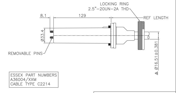
THIS DATA SHEET IS FOR IDENTIFICATION PURPOSES ONLY. NOMINAL DIMENSIONS IN MM. TECHNICAL DATA: **ACCESSORIES: INSTALLATION:** TERMINATION:-NOMINAL OPERATING VOLTAGE 75KV CABLE LENGTH TOLERANCE +/- 100mm CABLE SHOULD ONLY BE FITTED BY A TRAINED PERSON.
